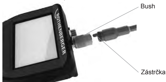
Obrázek 2 - Připojení kabelu (konektor Style A, černý)
