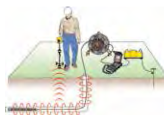
Vyhledání plastového potrubí pomocí trasování vnitřního potrubí.
