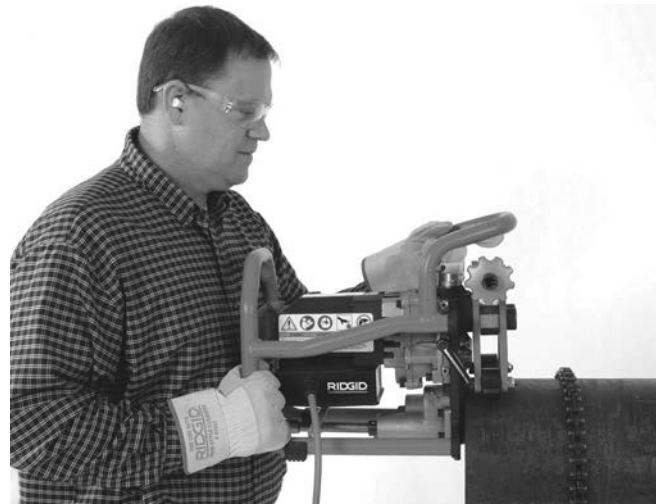
Obrázok 8A – Umiestnenie úkosovačky na rúru
