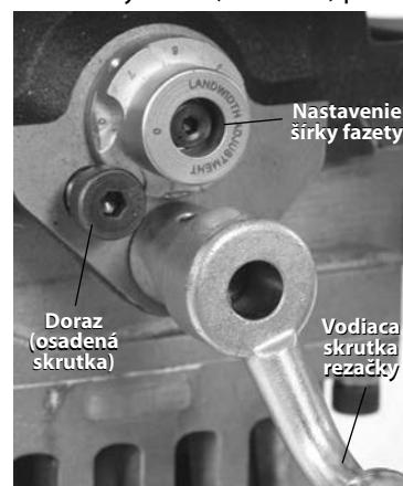
Obrázok 12 – Nastavenie nastavovacej šablóny pre šírku fazety
