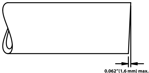
Obrázok 6 – Požiadavky na pravouhosť rúrky
