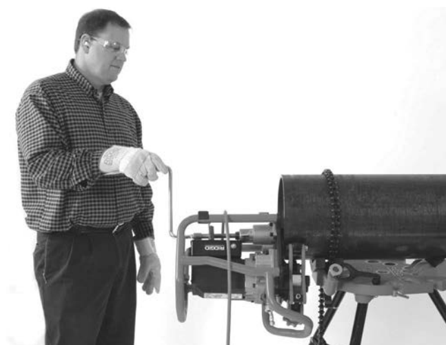
Obrázek 15B – Provedení ukosení
