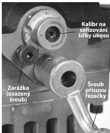
Obrázek 12 – Nastavení kalibru na seřizování šířky úkosu
