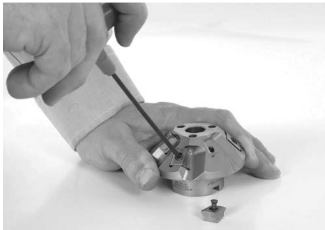
Obrázok 18 – Výmena rezných vložiek
