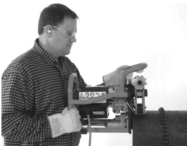
Obrázek 8A – Umístění úkosovačky na trubku
