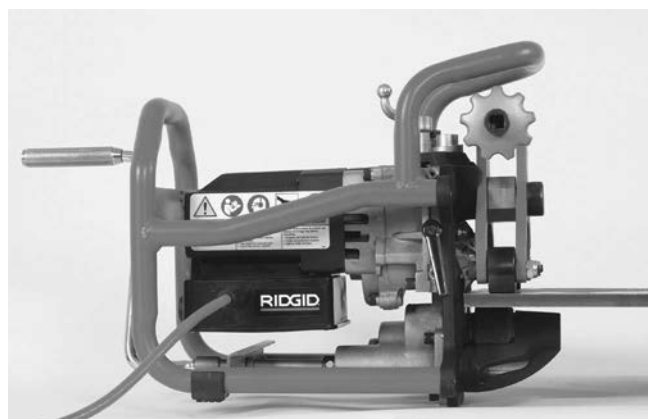
Obrázek 9B – Umístění úkosovačky na plech
