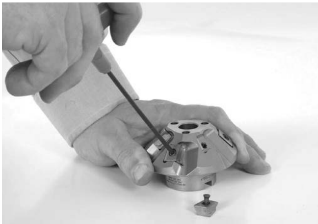
Obrázek 18 – Výměna řezacích vložek
