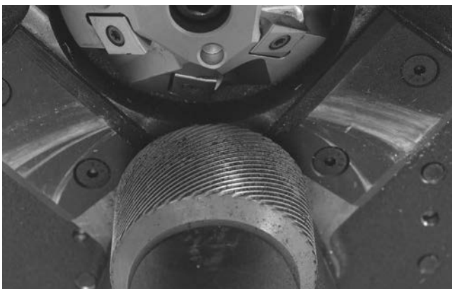
Obrázek 16 – Vyčistěte rýhování hnacího válce
