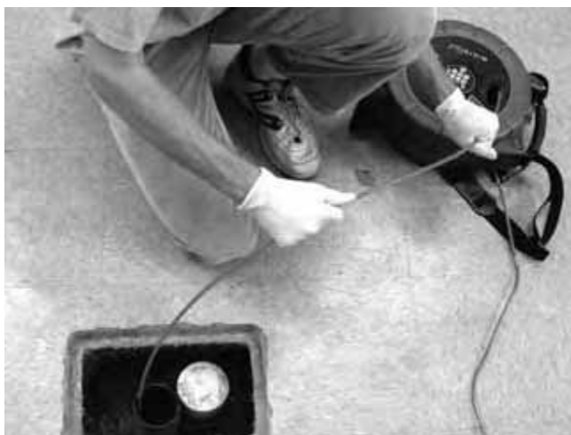
Obrázok 28 – Správna technika pri navíjaní kábla naspäť na bubon
