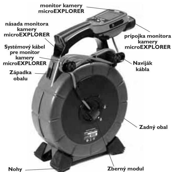
Obrázok 2 – Pohľad zozadu (nastavenie monitora kamery microEXPLORER)
