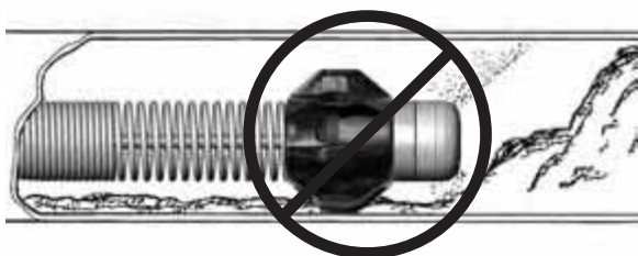
Obrázek 22 – Překážka v potrubí - Nepoužívejte hlavičku kamery k odstraňování překážek
