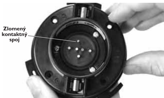
Obrázok 12 – Zlomený kontaktný spoj
