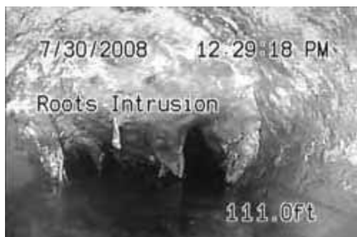
Obrázok 25 – Obrazovka displeja so zobrazením posuvného textu, času a vzdialenosti (Vzdialenosť sa meria od nulového bodu systému)
